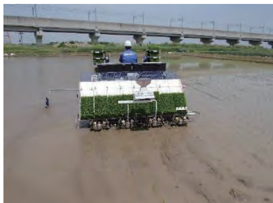
乗用田植機による株間を調整しての移植 草型の異なる飼料用イネ2品種を栽植密度を標準植(18.5株/m 2 )と疎植(11.1株/m 2 )に設定して移植しました
