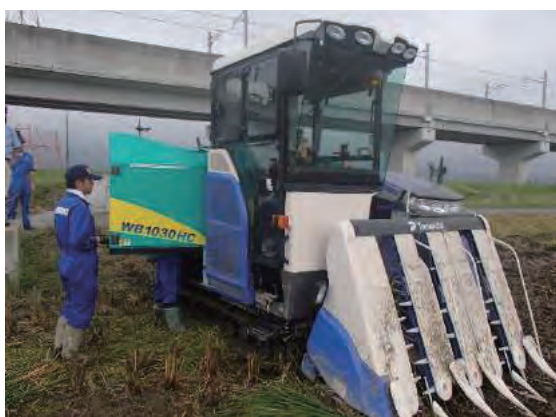
専用収穫機によるサイレージ収穫 機械メーカーの協力によりサイレージ用品種はホールクroppサイレージとして収穫しました
