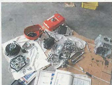
図1 実習で分解したエンジン
